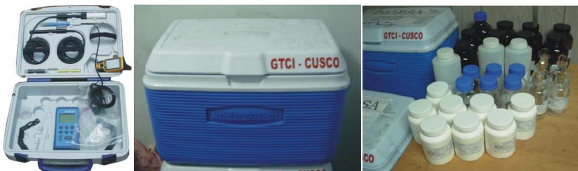
**Figura 7.1** Equipo Multi-parámetro Schott Multi-12 y GPS Garmin 60; Cooler para la preservación de muestras en frío (4 °C); Coolers y Frascos preparados para la toma de muestra
