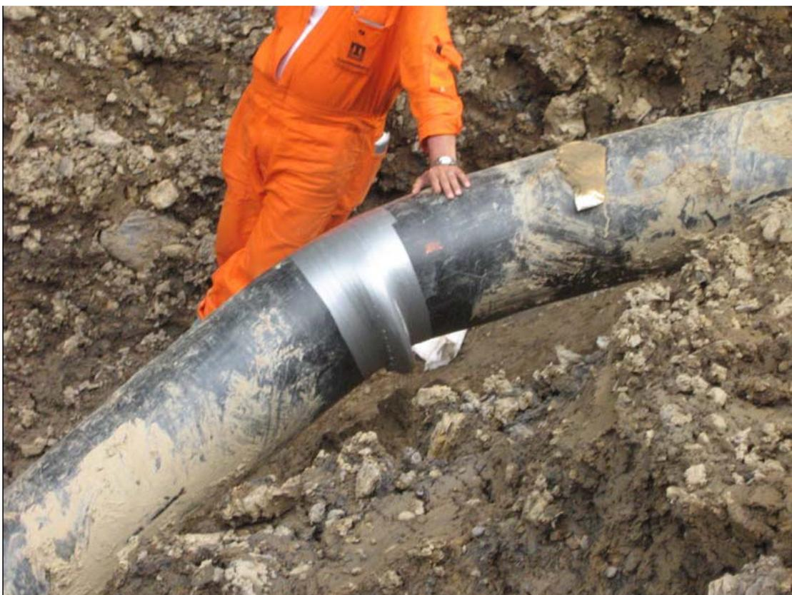
Vista del tramo fallado, nótese el pliegue formado.
